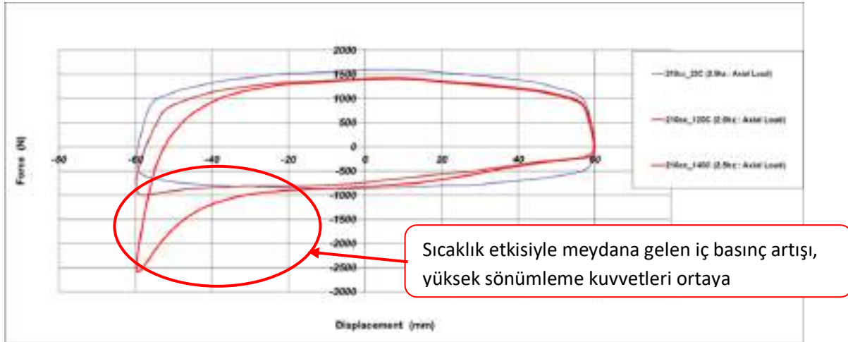
Şekil 14. 140°C Sıcaklık Ölçümü Loop Diyagramı
