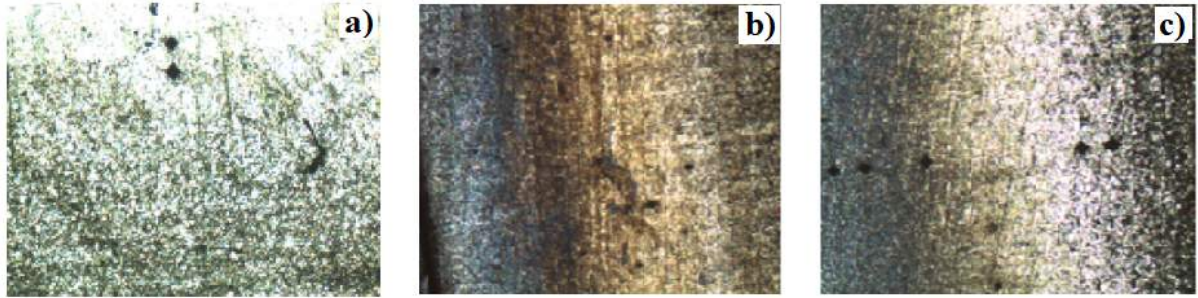
Şekil 3. 50x büyütme mikroyapı fotoğrafları, a) Kalınlık 15 mm/6 saat, b) Kalınlık 15 mm / 7 saat, c) Kalınlık 20 mm / 7 saat
