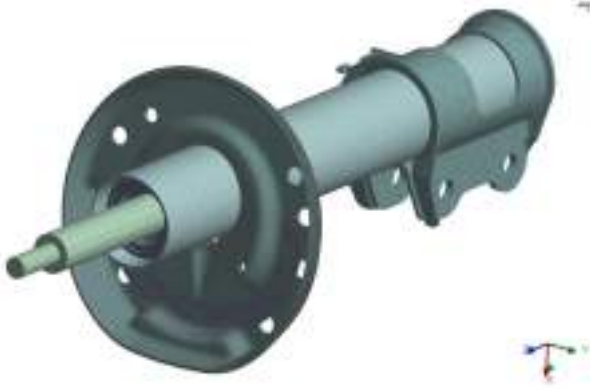
Şekil 6: Yay Çanağı Yorulma Analizi Ağ Modeli
