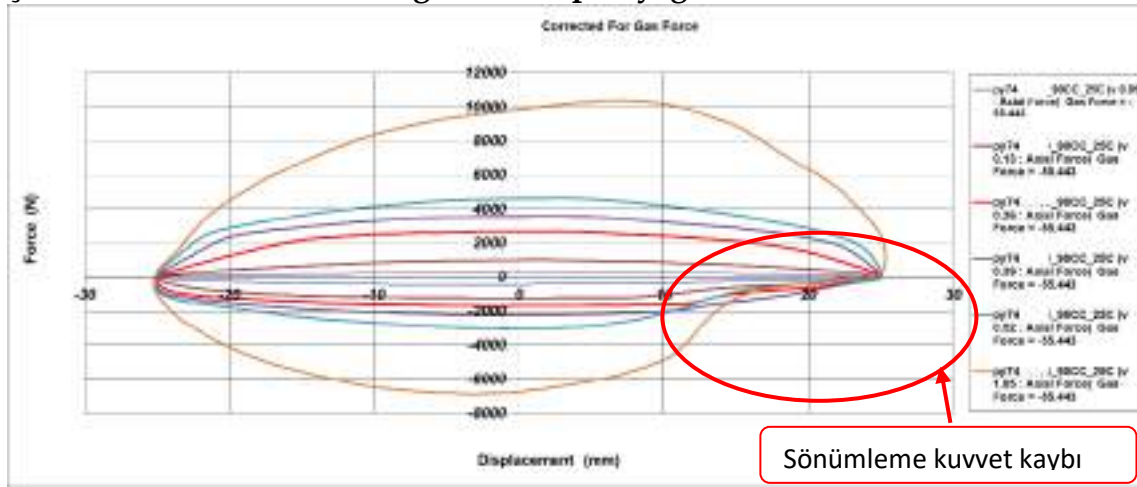
Şekil 11. 90cc Resim Hız Değerleri + Yüksek Hız Ölçümü Loop Diyagramı
