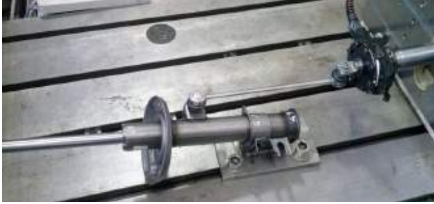
Şekil 9: Viraj Çubuğu Bağlantı Braketi Yorulma Test Düzeneği
