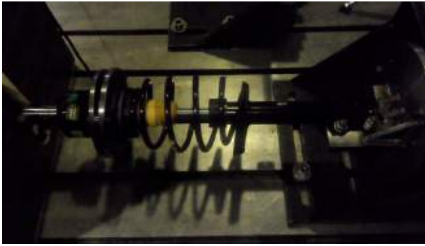
Şekil 10: Yay Çanağı Yorulma Test Düzeneği BULGULAR
