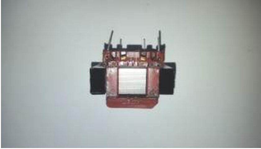
Şekil 6. Gövde kollarına ferromanyetik sıvı eklenen transformatörün üstten görünüşü.
