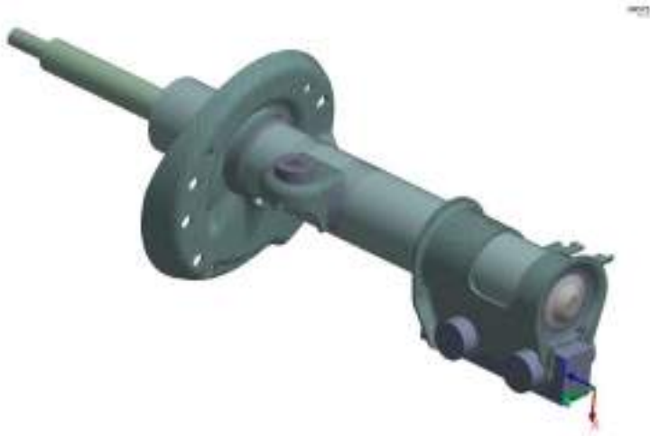
Şekil 4: Viraj Çubuğu Bağlantı Braketi Yorulma Analizi Ağ Modeli
