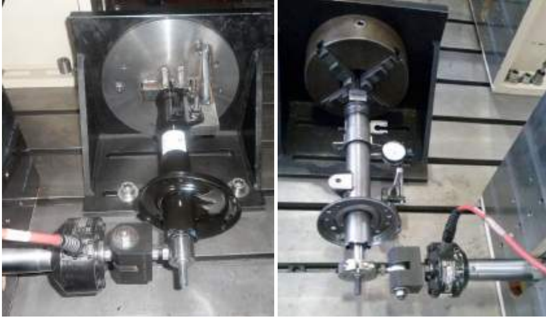
Şekil 8: Strut Rijitlik Yorulma Test Düzenekleri (Frenleme ve Viraj)
