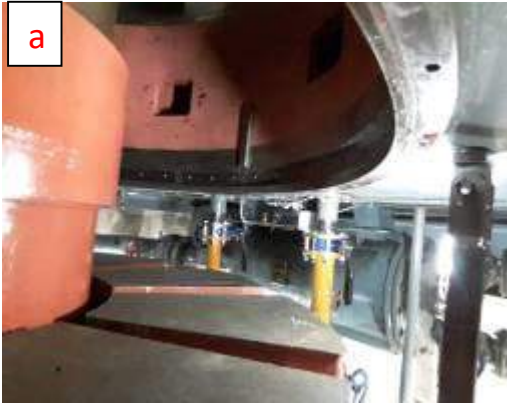
Şekil 2. a)Taşıyıcı yatak lokması, b)Taşıyıcı yatak ringi
