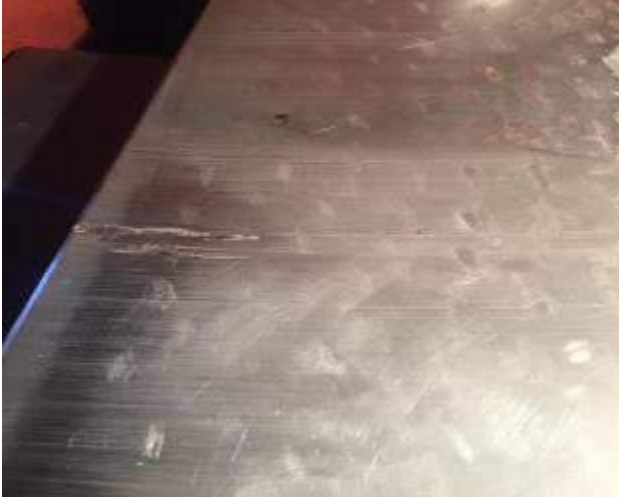
Şekil 3. Taşıyıcı yatak lokması beyaz metal deformasyon başlangıcı
