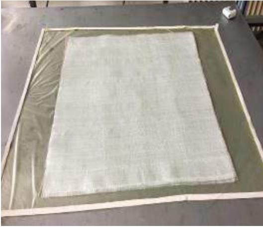
Şekil 4. Güneş Hücrelerinin Üzerine Cam Fiberlerin Serilmesi
