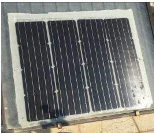
Şekil 7. Reçine Esaslı Kompozit Malzeme ile Kapsülennmiş Fotovoltaik Panel
